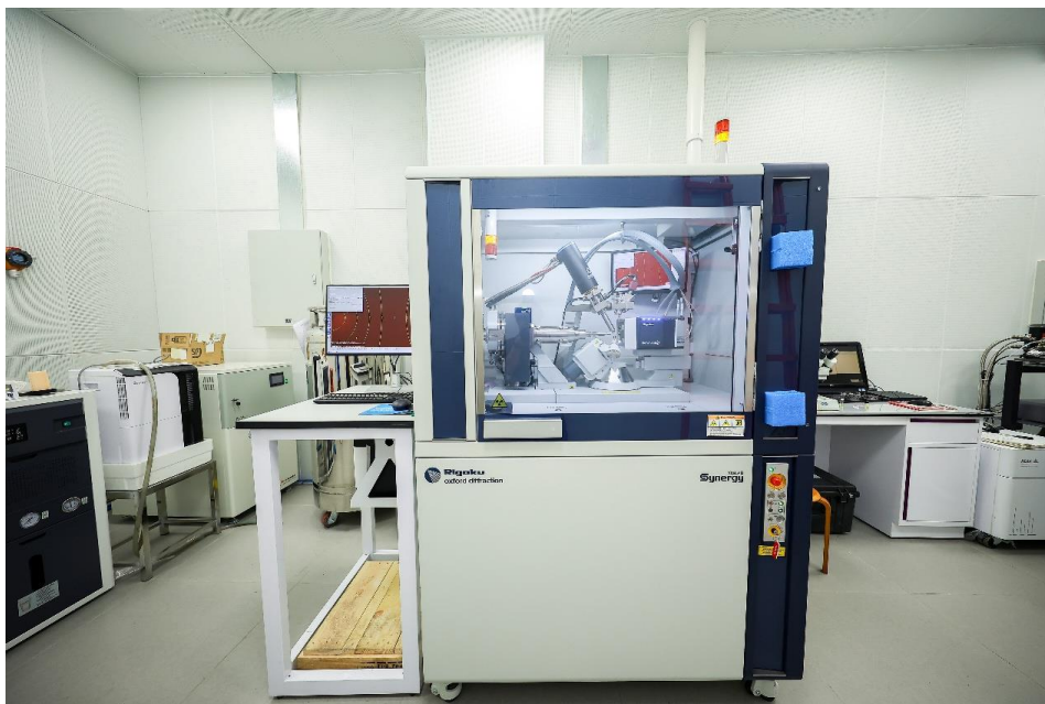
图 12 安装后的单晶 X 射线衍射仪
