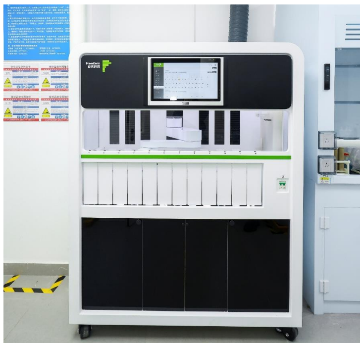
图 13 安装后的全自动微波样品处理平台
